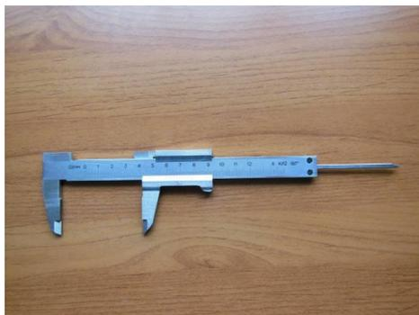
*Для замеров длины, глубины и диаметра деталей и разметки деталей.*
